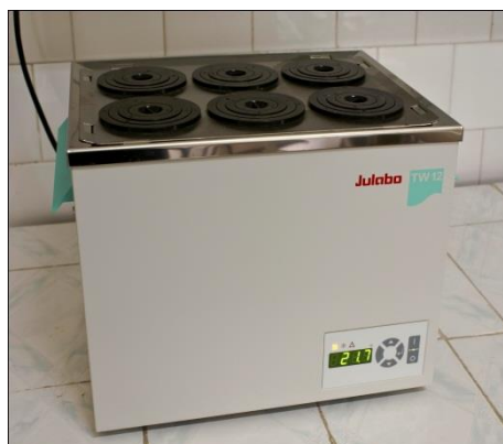
Baie de apă
